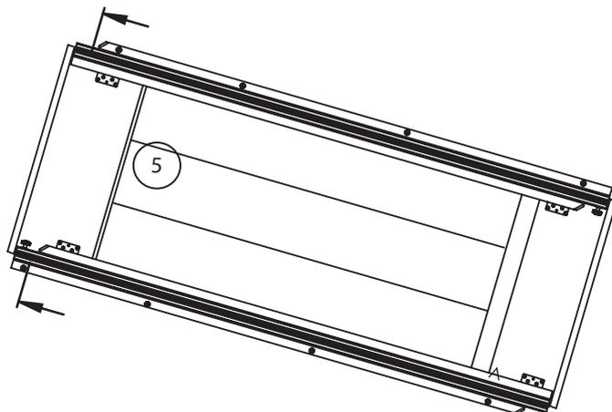
F) Posizionare la guida in metallo (5) sopra al basamento in metallo (1) in modo che corrispondano i fori delle squadre sotto la guida ai fori delle piastre del basamento e inserire le apposite 16 viti (da sotto le piastre).
