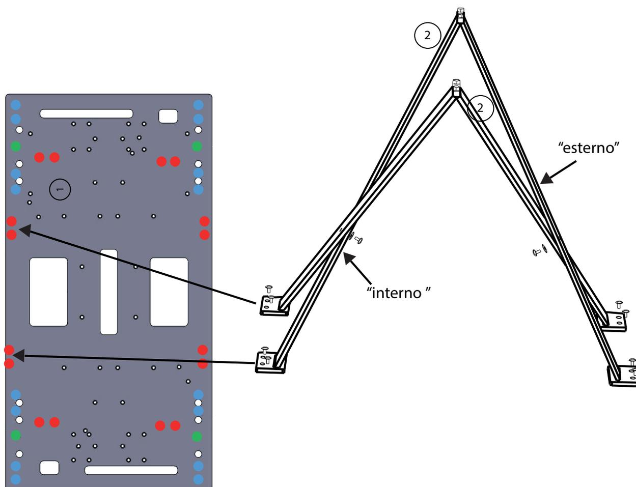
B) Posizionare le gambe CORTE (2) sulla piastra rispettando "interno ed esterno" come il disegno sopra illustrato ; poi avvitare le gambe alla piastra **SENZA SERRARE** e unire le due gambe **SENZA SERRARE**. (è importante non serrare alcuna vite finchè il tavolo non è ribaltato e posizionato nel pavimento)
